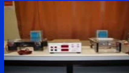
CELLA ELETTROFORETICA e GENERATORE DI CORRENTE per la corsa elettroforetica
